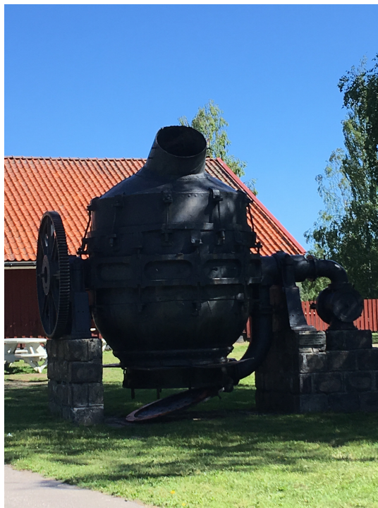
Bild 3: Bessemerkonverter från Sandviken; nu uppställd vid Högbo bruk.
